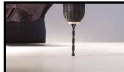
**Fig.8** - En ce qui concerne le perçage manuel, il est possible d'utiliser des forets au tungstène d'un diamètre pouvant aller jusqu'à 10 mm, montés sur une perceuse électrique ou une visseuse à piles.
