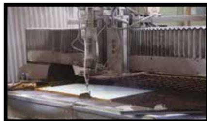
**Fig.17** - SLIMTECH, dans toutes ses versions, peut également être percé avec des machines à jet d'eau. Il est conseillé de procéder à une vitesse comprise entre 2 et 3 m/min.
