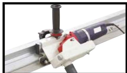
**Fig.6** - Avec la carrellette, il est également possible d'utiliser des ponceuses manuelles pourvues de guide de coupe. Il est ainsi possible de réaliser des découpes à 90° et à 45° et obtenir des bords adoucis ou encore des Jolly.
