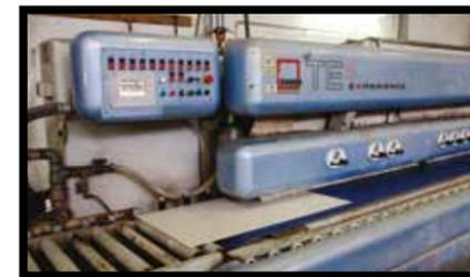
**Fig.20** - Pour la formation et le polissage du bord, utiliser des meules diamantées et abrasives afin d'obtenir un bord de la dimension et de la forme requises, puis une meule de polissage. De nombreuses finitions de bord sont réalisables en fonction du type de meule utilisée. Tester, au préalable, la vitesse d'avancement appropriée.
