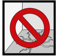
**Fig.27** - Avant de procéder à la pose, combler les éventuelles fissurations.
