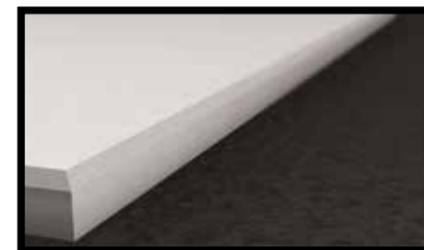
**Fig.22** - SLIMTECH, peut être chanfreiné, quelle que soit sa version. Pour chanfreiner les angles courbes, utiliser une machine à contrôle numérique avec une meule à 5 axes. De nombreuses finitions de bord sont possibles en fonction du type de meule utilisée. Tester auparavant la vitesse d'avancement appropriée.
