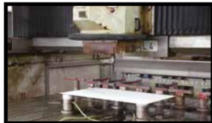
**Fig.16** - SLIMTECH, dans toutes ses versions, peut également être percé avec des machines à contrôle numérique. La fraise de ces machines requiert une vitesse de rotation comprise entre 12 000 et 18 000 tr/min, et une vitesse d'avancement comprise entre 0,5 et 1 m/min.
