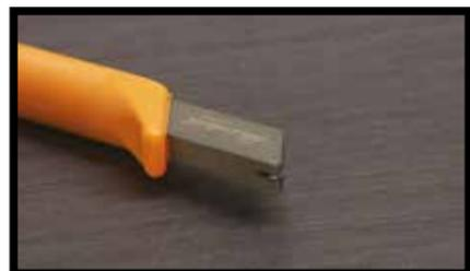
**Fig.1** - On peut découper et façonner SLIMTECH, dans toutes ses versions, avec des coupe-verres Silberschnitt 2000 commercialisés par la société **Bohle Italia** ou à l'aide d'une carrellette manuelle comme celle de la société **Würth**. Pendant toute l'opération de découpe, il est important de ne pas détacher le coupe-verre de l'axe d'incision.
