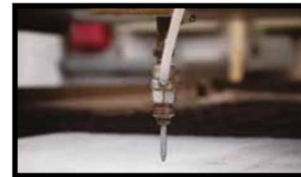
**Fig.19** - SLIMTECH, dans toutes ses versions, peut également être percé avec des machines à jet d'eau.
