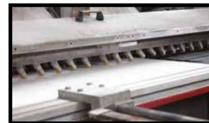
**Fig.21** - Pour une découpe à 45°, il est possible d'utiliser des disques diamantés inclinés à 45°. De cette façon, vous pouvez réaliser un angle avec deux dalles de SLIMTECH, quel que soit leur version. L'angle obtenu devra ensuite être chanfreiné. De nombreuses finitions de bord sont possibles en fonction du type de meule utilisée. Tester auparavant la vitesse d'avancement appropriée.
