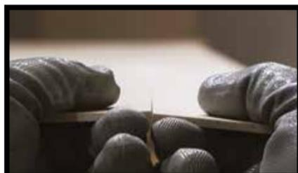
**Fig.3** - Au terme de l'incision, il suffira d'exercer une légère pression pour que les deux pièces se détachent.
