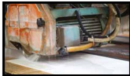
**Fig.15** - SLIMTECH, dans toutes ses versions, peut également être découpé avec des disques diamantés. Les disques doivent être adaptés au grès cérame et en parfait état. Il est conseillé de procéder à une rotation élevée (>2000 tours/min) et à une vitesse d'avancement comprise entre 0,5 et 1 m/min. Le refroidissement du disque de la scie, à l'aide d'eau, peut parfois s'avérer nécessaire selon le type de scie et la longueur de la coupe.
