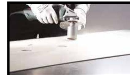
**Fig.9/10** - On peut également utiliser un trépan monté sur ponceuse, une perceuse électrique ou encore une visseuse à piles.
