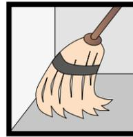
**Fig.26** - La surface du support doit être propre. On devra éliminer toute trace de poussière, d'huile ou autre déchet afin de ne pas compromettre l'adhérence du mortier-adhésif.
