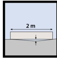
**Fig.24** - La vérification de la planéité doit s'effectuer avec une règle de 2 m minimum, en la posant sur le support dans toutes les directions. La tolérance admise est de 2 mm.
